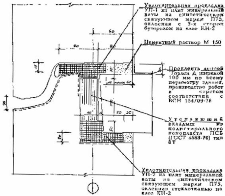
Рис. 2. Заделка стыковых соединений наружных стен и панелей перекрытий
