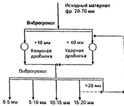
Рис. 2. Технологическая схема дробильно-сортировочной установки с использованием параллельно работающих конусной и ударной дробилок
