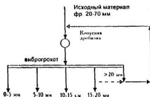
Рис. 1. Технологическая схема дробильно-сортировочной установки с использованием конусной дробилки
