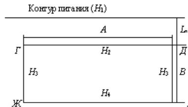
Рис. 1. Схема к расчету водопритоков к одиночной выработке
