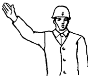
Рис. 1. Руку быстро поднять вверх с наклоном вперед, ладонью в сторону крановщика (лебедчика)
