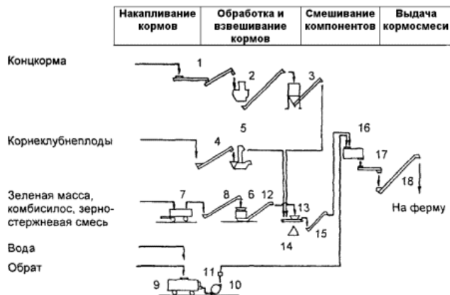
Рисунок В.8 - Технологическая схема подготовки и раздачи кормов на фермах крестьянских хозяйств по производству молока с использованием мобильных универсальных агрегатов, оборудованных приспособлением для дозированного ввода концентрированных кормов
