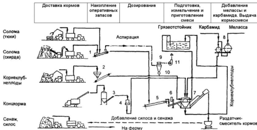
Рисунок В.1 - Технологическая схема кормоцеха для крупного рогатого скота
