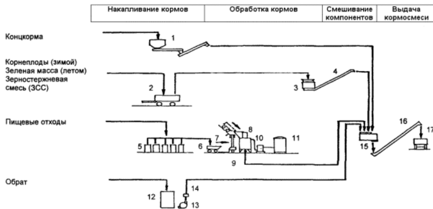
Рисунок В.9 - Технологическая схема кормоцеха с весовым дозированием кормов свиноводческих крестьянских хозяйств
