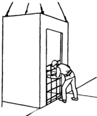
12 КРЕПЛЕНИЕ ПРЕДЫДУЩЕГО БЛОКА ЭЛЕКТРОСВАРКОЙ; 12 мин; Э; комплект инструментов электросварщика, сварочный аппарат
