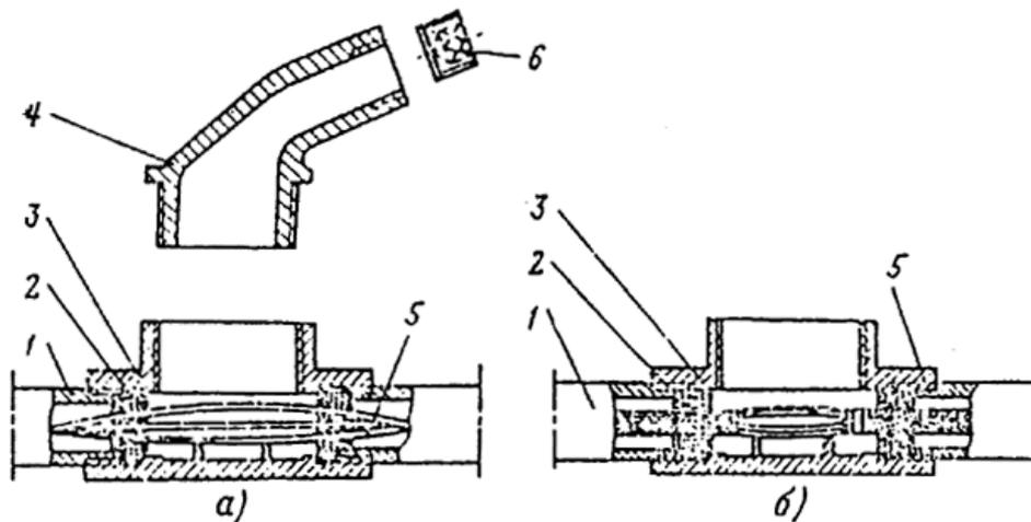
Рис. 37. Подготовка коробки КПЛ для выполнения разделительного уплотнения.
