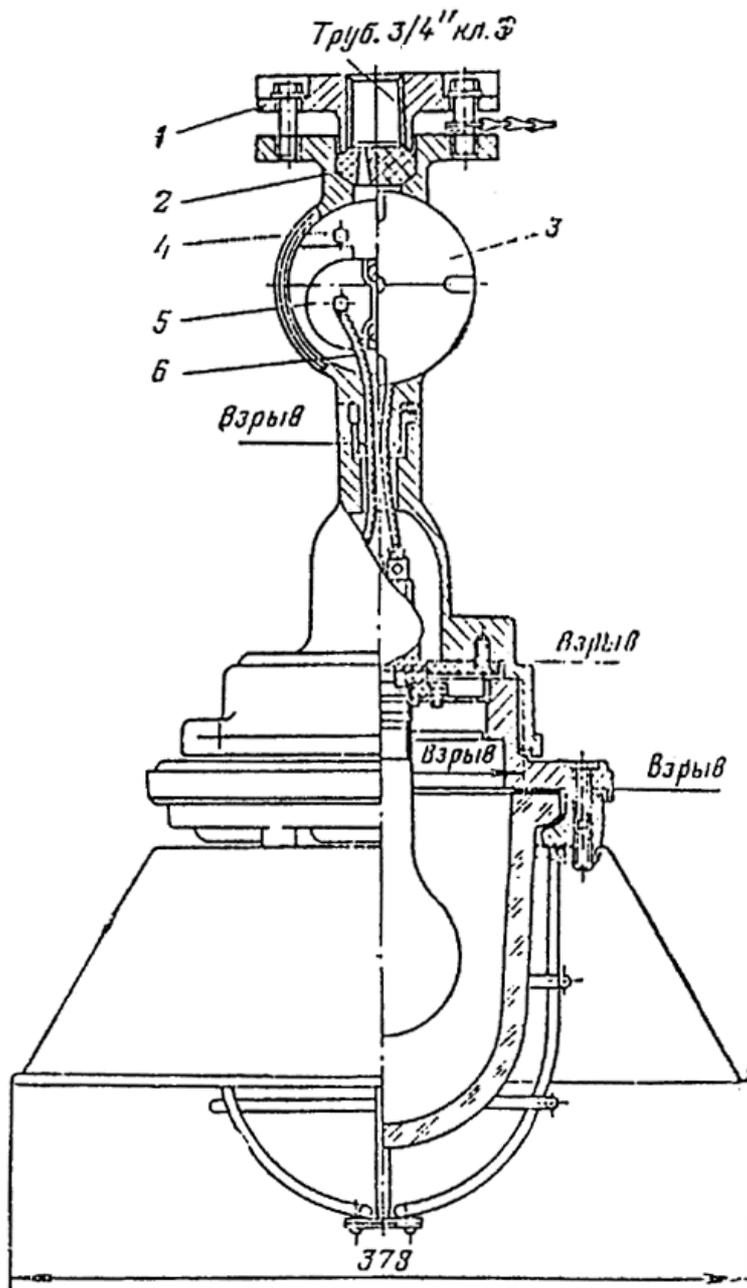
Рис. 86. Светильник ВЗГ/В4А-200М.
