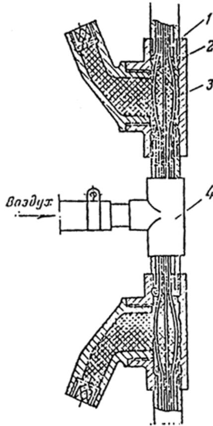
Рис. 35. Устройство разделительных уплотнений с локальным испытанием в коробках КГП.
