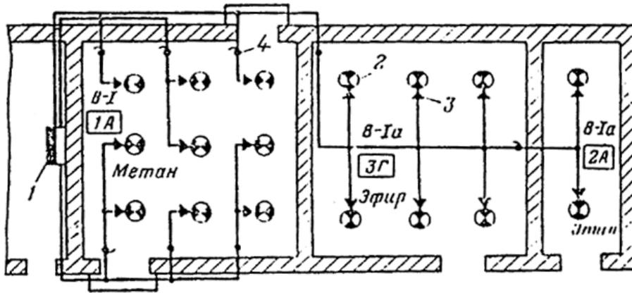
Рис. 32. Размещение разделительных уплотнений для осветительной сети.
