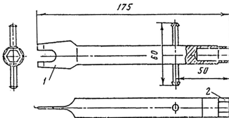
Рис. 97. Ключ для светильника Н4Б-300.
