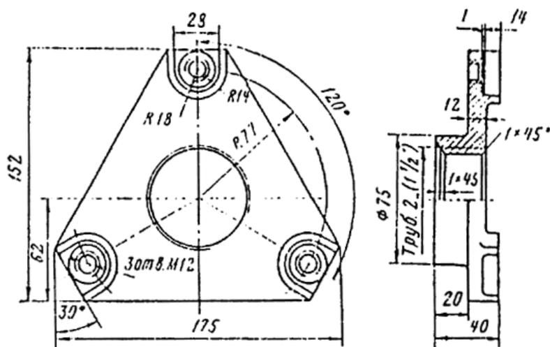
Рис.60. Нажимная муфта вводных устройств К-2, К-3, К-5.
