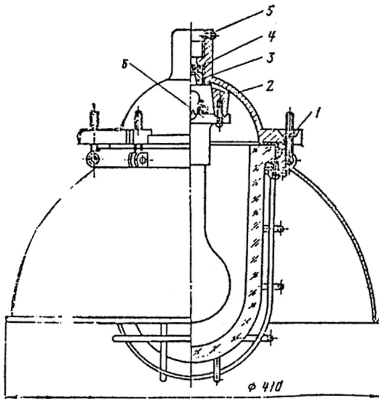
Рис. 95. Светильник повышенной надежности против взрыва типа H4B-300.
