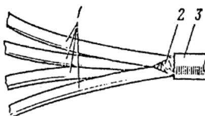
Рис.48. Трубки ХВТ, надетые на жилы кабеля.
