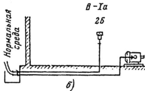
Рис. 33. Пример установки разделительных уплотнений при проходе труб из взрывоопасного помещения в нормальное.
